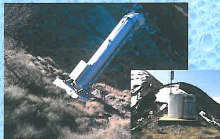
Sistema GAZ.EX: cannone per l'innesco artificiale delle valanghe
